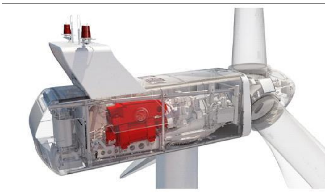
Figure 16 : Localisation du générateur
